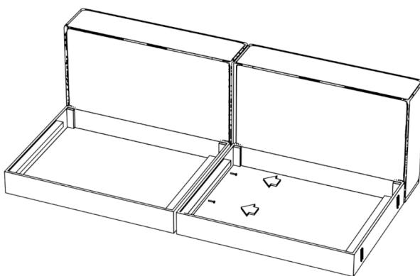
1. Устанавливаем бельевые ящики со спинкой на пол и скрепляем их между собой на два болта.
